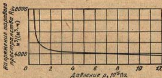
Рис. 4.20. Изменение предельного напряжения парового пространства при кипении воды R_v^* от давления p
