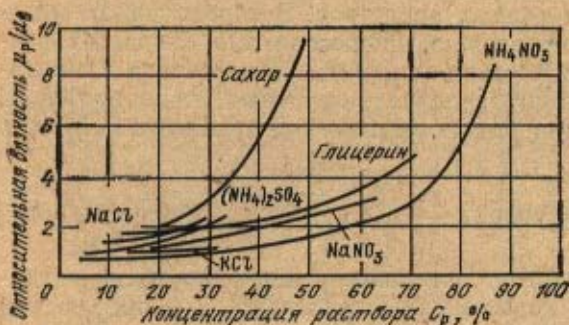
Рис. 4.3. Изменение относительной вязкости водных растворов в зависимости от концентрации
