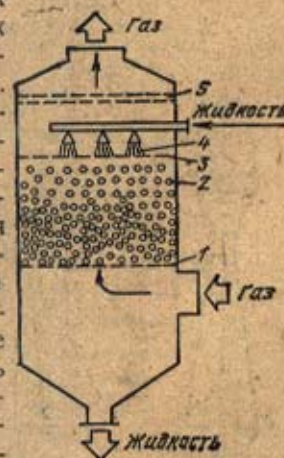
Рис. 5.12. Скруббер с псевдооживленной насадкой
